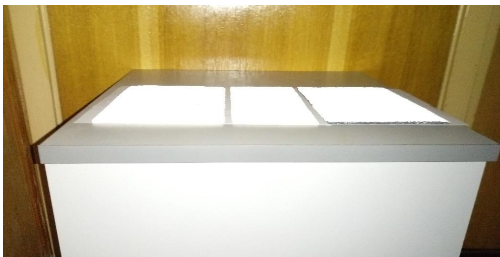
Рис.5 Световозвращение образцов холодного пластика, представленных выше на рис. 4, при боковом освещении в темное время суток.
